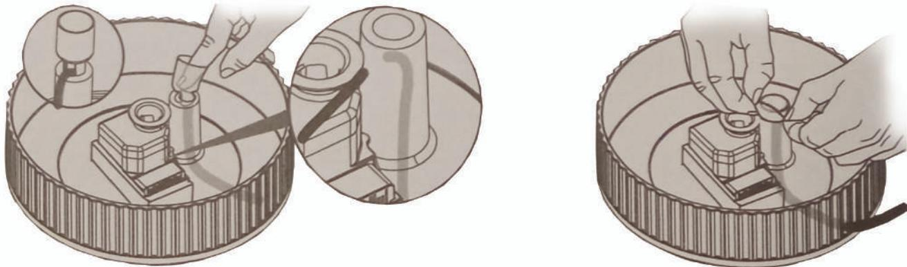
4. Τοποθετήστε προσεκτικά τον πύργο του συντριβανιού στο μπολ. Το ελαστικό πώμα πρέπει να είναι ευθυγραμμισμένο και να συνδέεται στην έξοδο νερού του κουτιού του φίλτρου.
